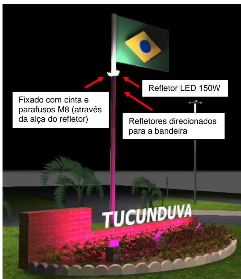
Figura 6 – Refletores fixados no mastro
